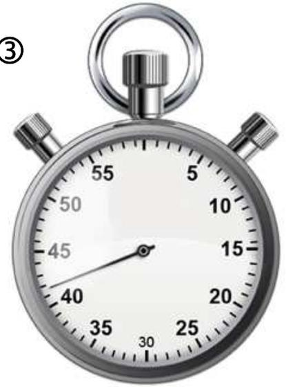
**La résolution** d'un appareil de mesure est la plus petite variation de la grandeur mesurée qui produit une variation perceptible de l'indication délivrée par l'instrument.
